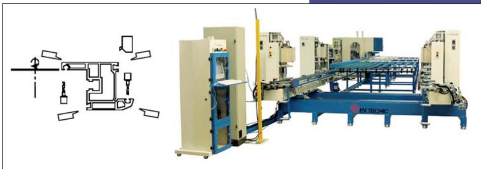
Для производства сложных изделий и конструкций из алюминия компания COMALL (Италия) предлагает автоматический копировально-фрезерный обрабатывающий центр WIN 400 SC, в котором воплотились самые последние разработки инженеров компании. Центр полностью автоматизирован, CNC управление, есть возможность управления с ПК. Центр предназначен для обработки алюминия и стали.
